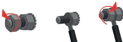
Rys. 4. Podłączenie urządzenia do instalacji wyrównującej potencjały elektryczne.
