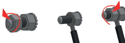
Obrázok 4. Pripojenie zariadenia do inštalácie na vyrovnávanie elektrických potenciálov.
