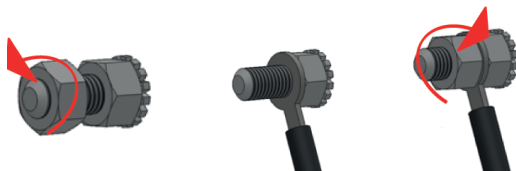
Figura 4. Conexión del equipo a una instalación equipotencial.
