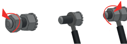
Bild. 4. Der Anschluss des Gerätes an die Einrichtung zum Potentialausgleich.
