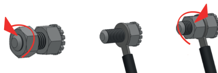
Fig. 4. Raccordement de l'appareil à une installation équipotentielle.
